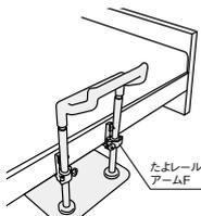
●手すりをベースプレート中央に取付ける場合や、ベースプレート端部に内向きで取付ける場合は、ベッドフレームから離して右図のように使用できます。
