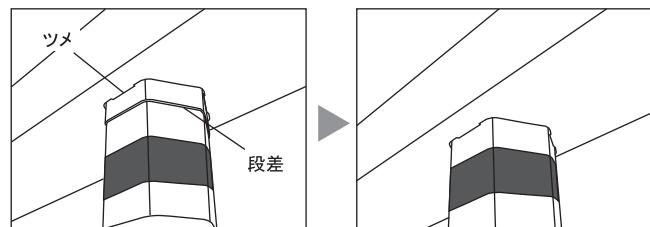
天井用ベースプレートのツメが手すりユニットの段差を越えるまで差込む。
