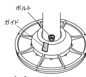
! ベースプレートのガイドとボルトが同じ方向を向くように調整する。
