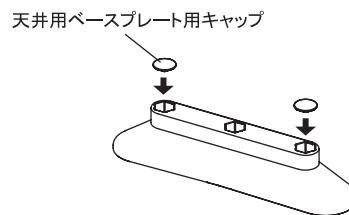
2. 手すり・ベースユニットの先端に天井用ベースプレートをしっかり差込む。
