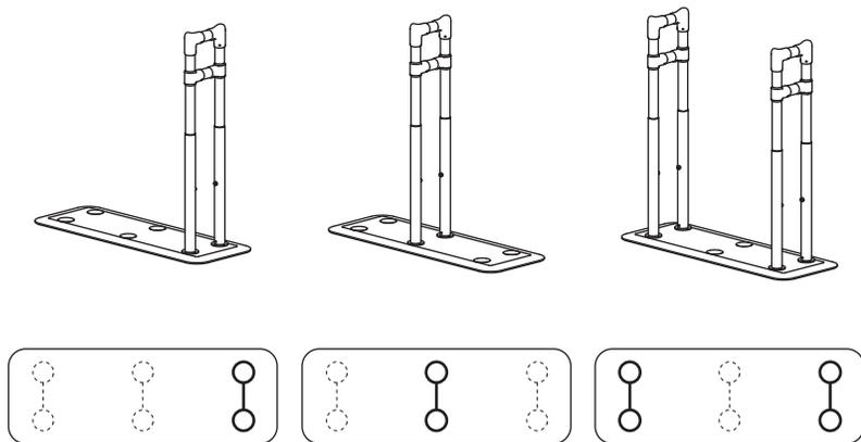
3. ベースマットSスリム型の吸着面を下にして、たよレールSOTOEスリム型の手すりに通す。
