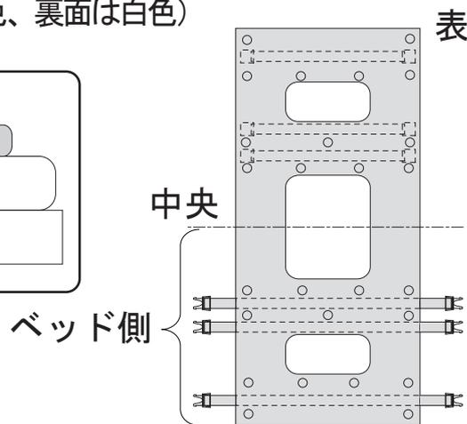
2. バックル取付けひもを緩めた状態であることを確認し、縦手すりに左右にあるバックルをカチッと音が鳴るまで差し込み、仮止めする。
