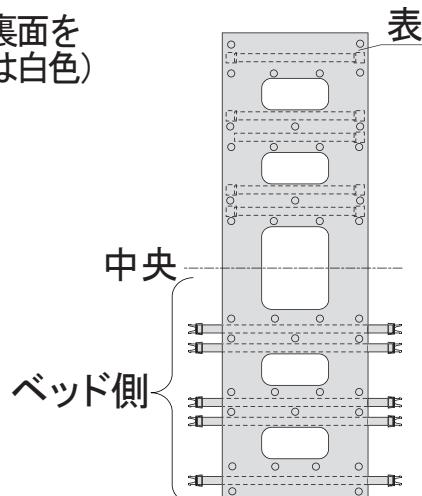
2. バックル取付けひもを緩めた状態であることを確認し、縦手すりに左右にあるバックルをカチッと音が鳴るまで差し込み、仮止めする。
