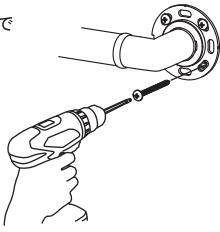
（×）・手回しでねじを取付けない。ガタツキや脱落の原因となる。
