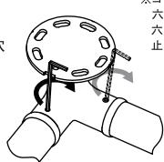
（○）・六角穴付き止めねじは接続部品に接触してから2回転半以上
