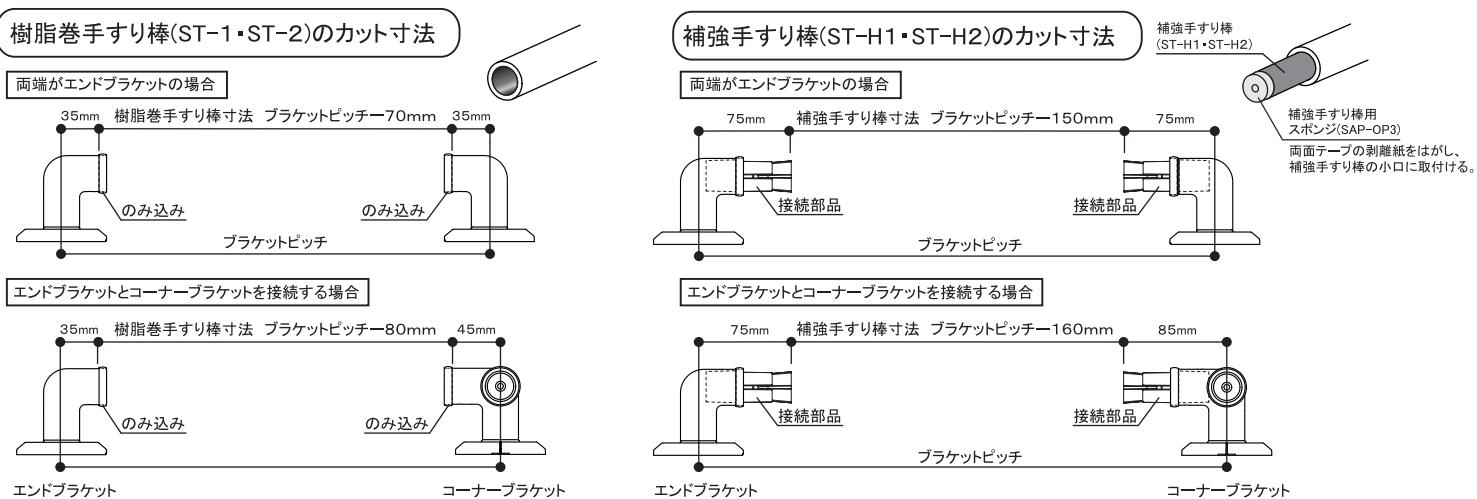
○ 補強手すり棒は必要寸法より短くカットしない。
