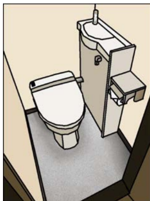
（図2）立ち上がり前方にスペースを設けた洋式トイレ
