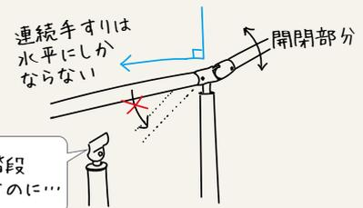
こちらの現場では傾斜部分の手すりに使用するため、「遮断機式用自在ジョイント」を併用されました(2か所)。
