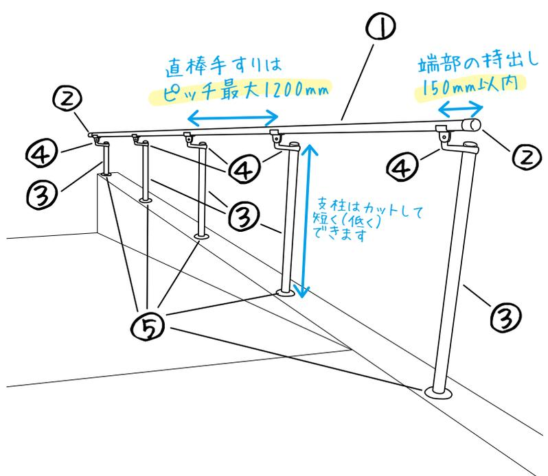
※ベースプレート式で施工する場合、アンカー用下穴のヘリあき寸法は100mm以上必要です。
