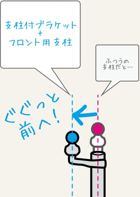
支柱付ブラケットを用いて、手すりを「ぐいっ」と通路側に持出しています。カーポートの柱も避けられ、より体に近い位置で手すりを使うことができます。
