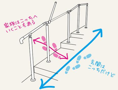
遮断機式支柱は頭部分に遮断機のメカがついています。強度を担保するため、そのままでは開閉しない方の手すりが水平にしかならない設計なので...
